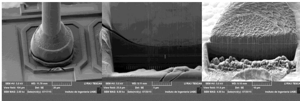
Figura 23.2 FIB Cobre (Cu) Segundo punto de contacto
