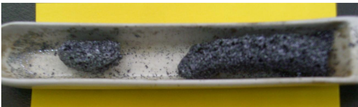
Fig. 26 Muestra SH4 al final del proceso de descomposición
