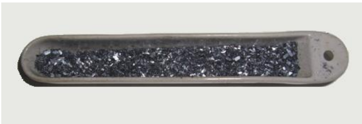
Fig. 25 Muestra SH3 al final del proceso de descomposición
