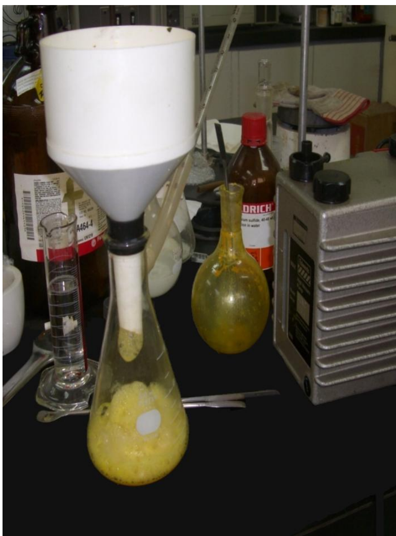
Fig. 17 Filtración para obtener el precursor TTCTMA*
