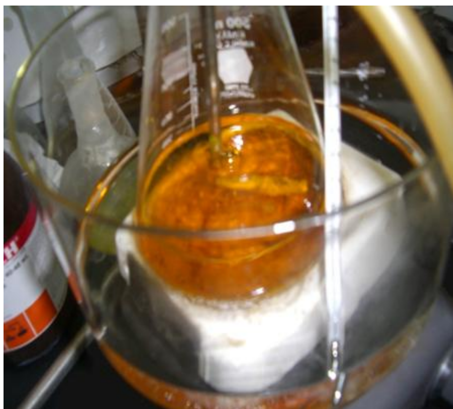
Fig. 10 Síntesis del precursor tetratíotungstato de amonio
