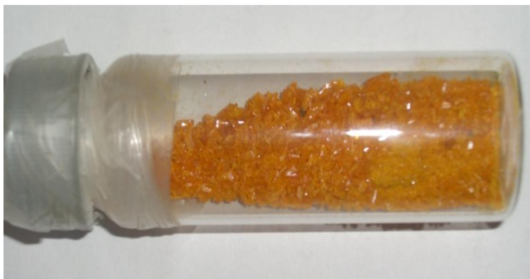
Fig. 12 Cristales secos de (\text{NH}_4)_2\text{WS}_4
