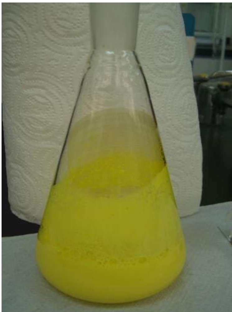
Fig. 14 Solución acuosa de (\text{NH}_4)_2\text{WS}_4 con solución CCTA después de agitar
