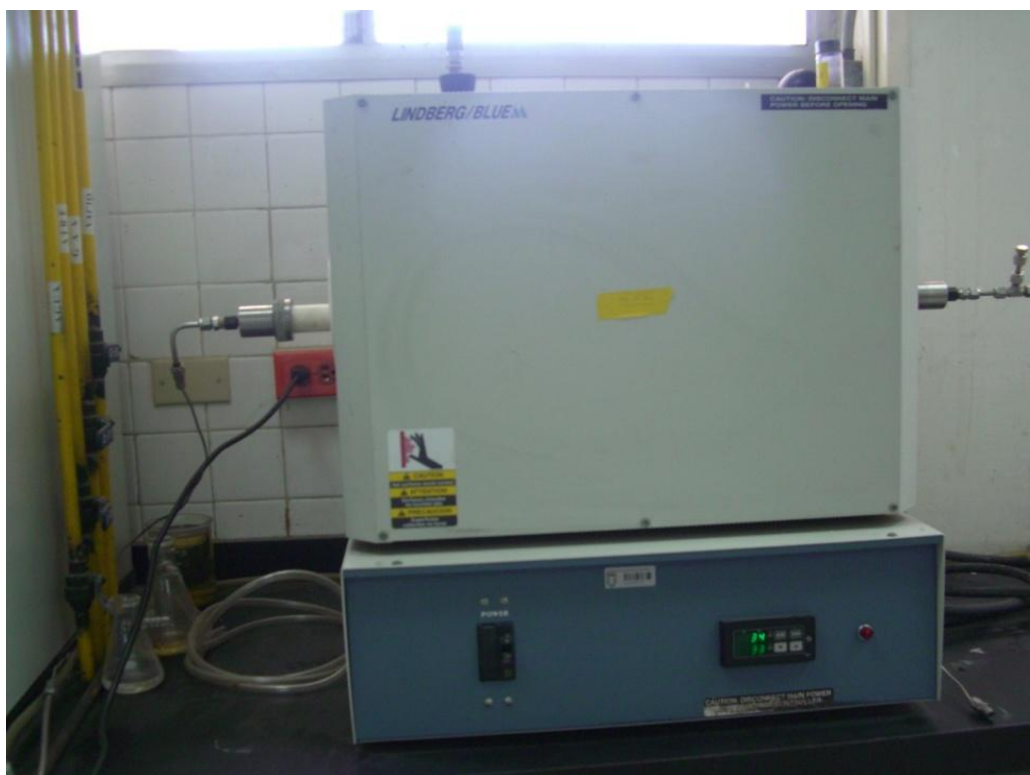
Fig. 20 Descomposición de los precursores en un horno
