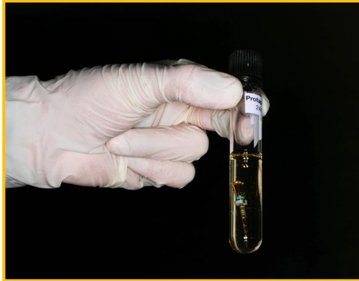
**Figura 8. Lima endodónica rotatoria NiTi sumergida en TBS.**
