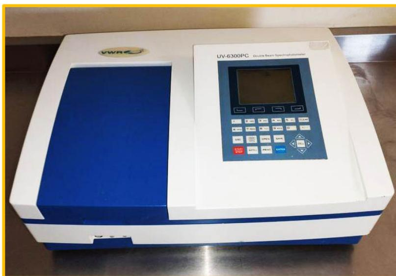
Figura 14. Espetrofotometro UV/Vis, UV-6300PC
