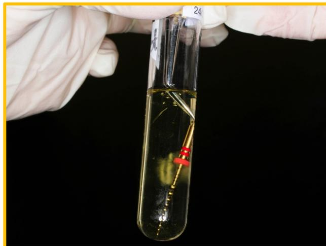
**Figura 11. Extracción de lima endodóntica rotatoria del tubo con TBS.**
