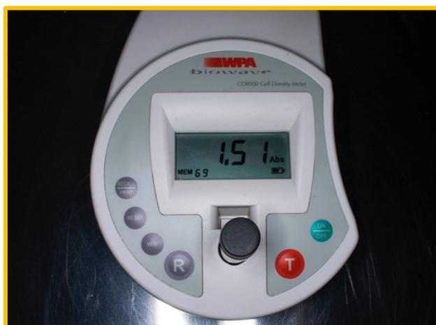
**Figura 13. Muestra colocada en el espectrofotómetro(Biowave Cell Density Meter CO8000).**
