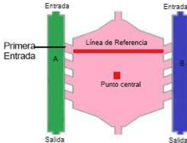
Figura 12. Geometría del dispositivo microfluídico usada para el modelado computacional: Canales laterales A y B (verde y azul) y cámara central (rosa) la cual está llena de hidrogel. Línea de referencia y punto central en la microcámara usadas para las variables representadas dentro del dispositivo (Bonifacio et al. , 2019, fig. 1).
