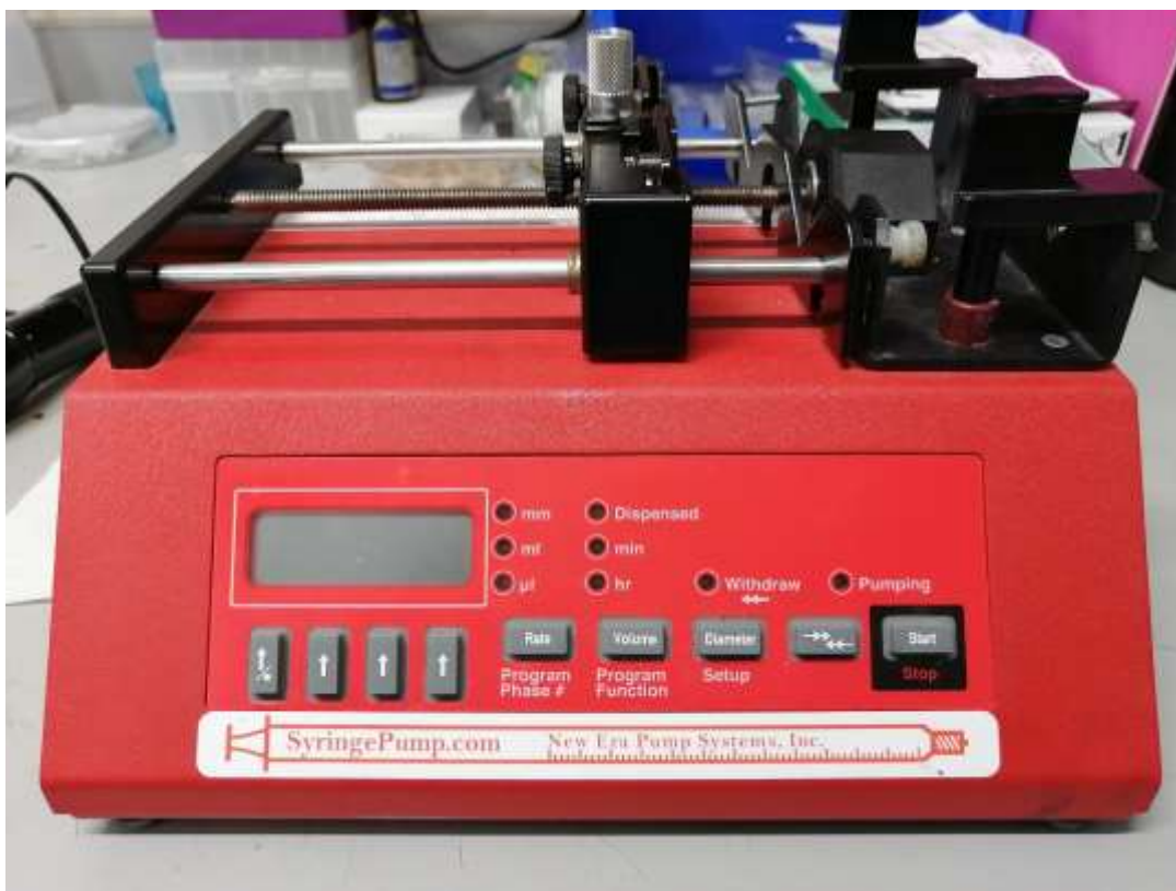
Figura 35. Microbomba Syringe Pump Multi-Phaser NE-4000 utilizada para impulsar el aceite mineral y el agua destilada con colorante.
