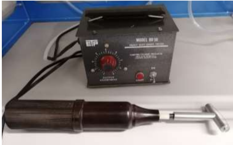
Figura 31. Pistola de corona de plasma. En la parte superior se observa el regulador de voltaje y controlador. En la parte inferior se observa la pistola de plasma con electrodo de cable arqueado.
