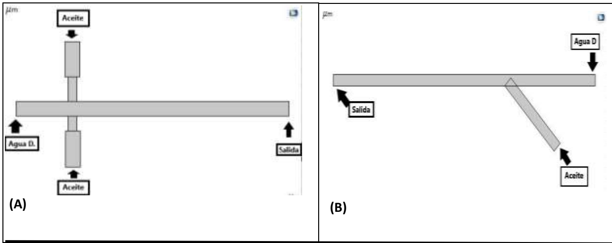
Figura 23. Ubicación de la entrada de los fluidos en los dispositivos generados en COMSOL. (A) Dispositivo microfluídico tipo cruz con una entrada de agua destilada en el microcanal horizontal y dos entradas de aceite mineral en los microcanales perpendiculares al flujo del agua. (B) Dispositivo tipo Y con una entrada de agua destilada en el microcanal horizontal y una entrada de aceite mineral en el microcanal inclinado a 45°
