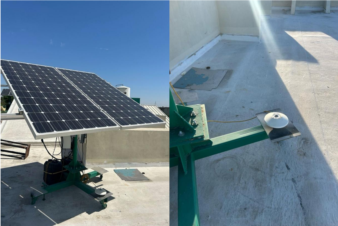
Figura 32. Instalación del piranómetro debajo del pilotaje experimental.
