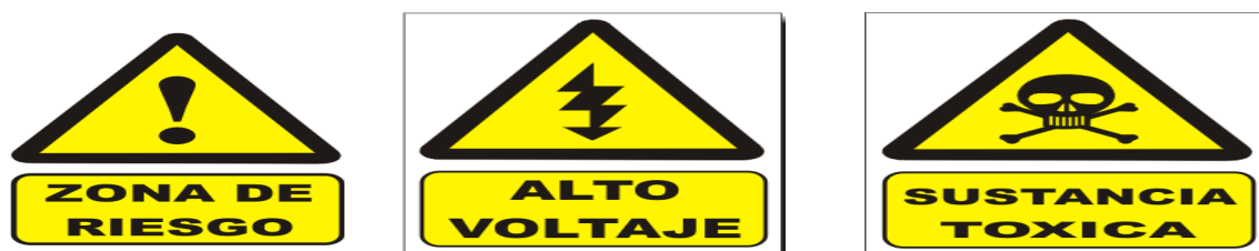
Figura: 5.3.4 Señales de advertencia
