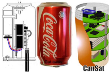
Figura 11: Concepto del CanSat, los subsistemas de un satélite real dentro de una lata común.[29]
