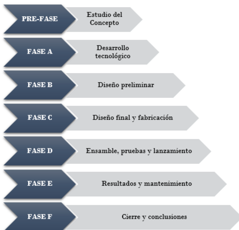
Figura 21: Sistema de ingeniería NPR 7120.5, empleado en este trabajo.[30]
