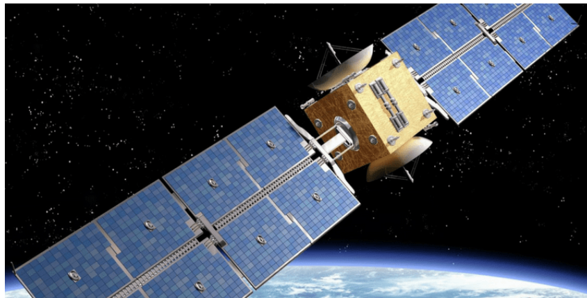
Figura 9: Subsistema de energía con paneles solares.[35]
