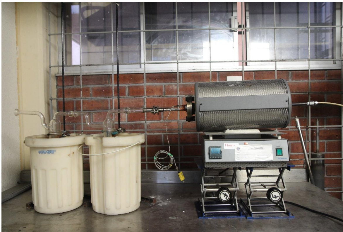
Figura 83. Sistema de pirólisis instalado.
