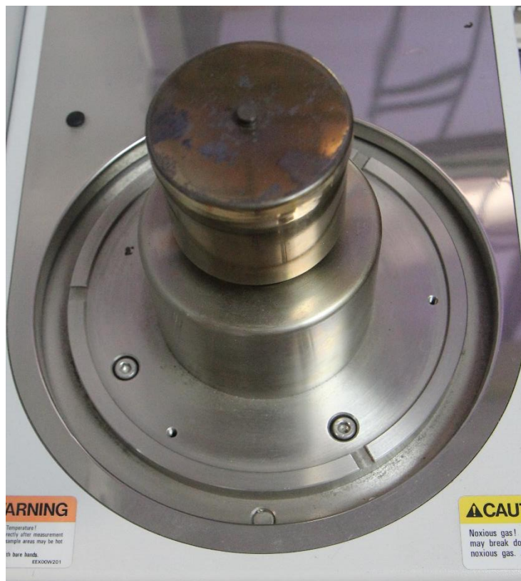
Figura 67. Calorímetro cerrado con la muestra contenida dentro.
