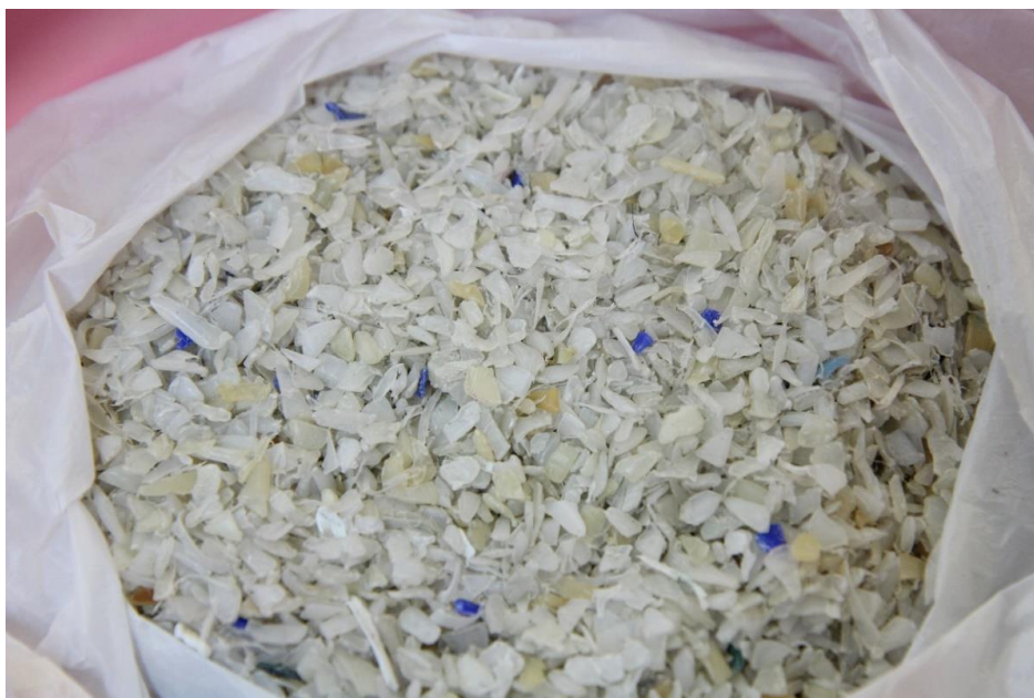
Figura 62. Plástico tamizado a un tamaño de partícula máximo de 5 mm.
