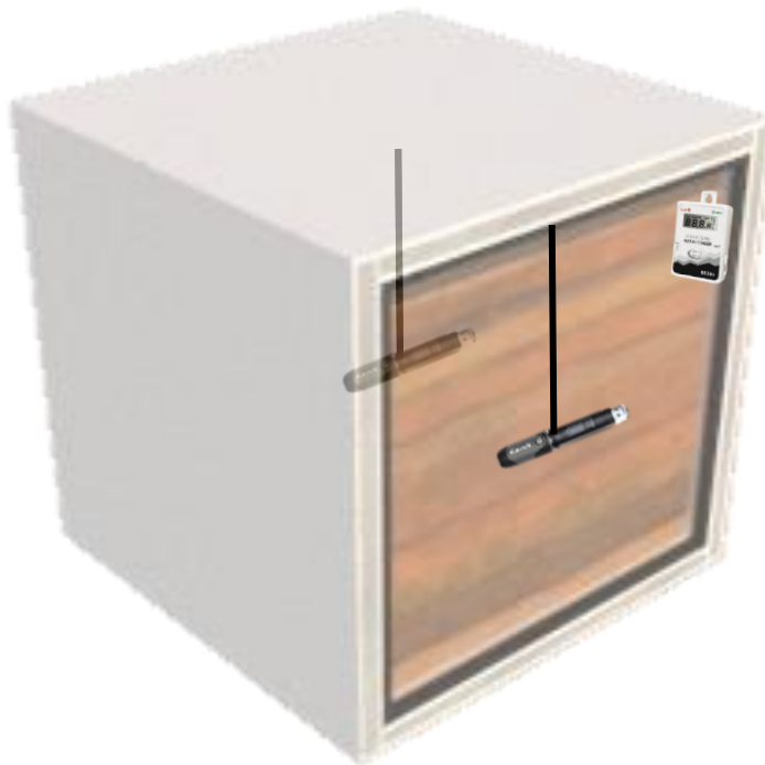
Figura 41. Ubicación de sensores en cada módulo experimental. Fuente: Elaboración propia.
