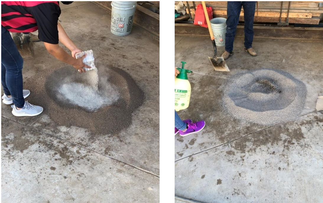
Figura 32. Izquierda. Aplicación de 5% del agregado de cemento. Derecha. Aplicación del 10% de agua. Fuente: Elaboración propia.
