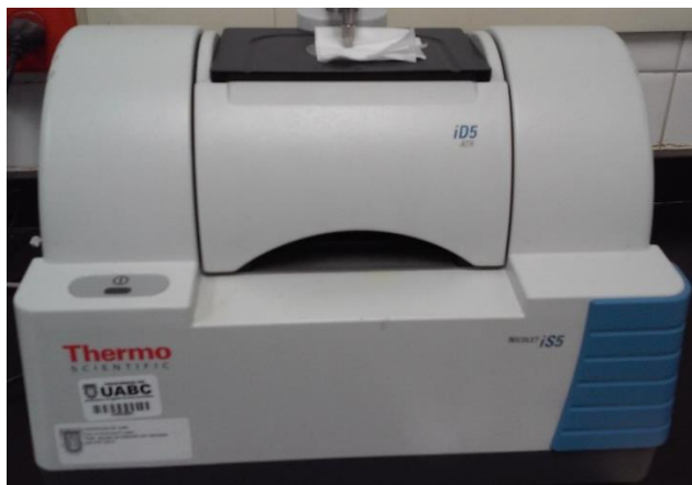
Figura 29 Espectrómetro FT-IR Modelo Nicolet is5
