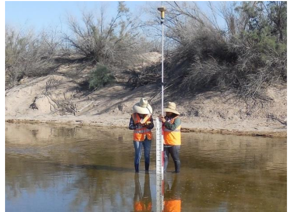
Figura 6. Nivelación de limnómetro DMS-4
