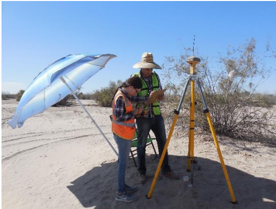
Figura 5. Instalación de antena base
