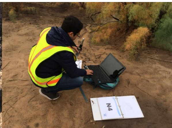
Figura 12. Obtención de datos de transductores en piezómetro N4
