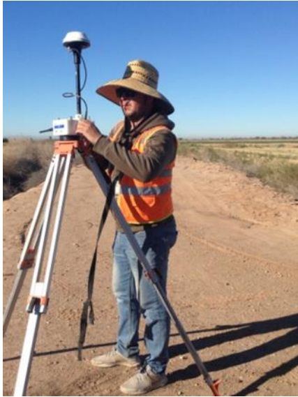
Figura 8. Instalación de antena base
