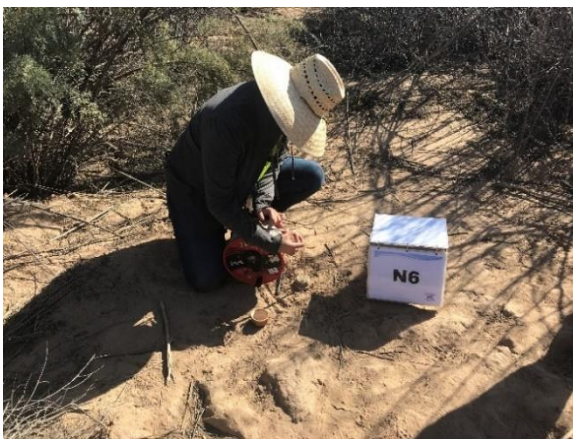
Figura 11. Medición de la profundidad del nivel freático en el piezómetro N6
