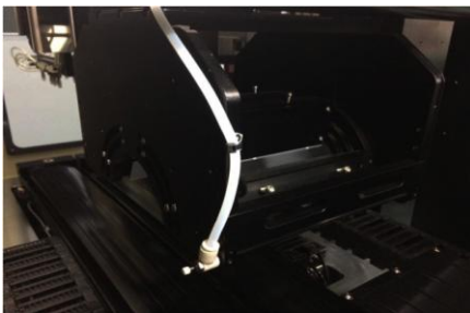
Figura 42: MexDMT RM sorteadora utilizando el lector de 2D en la máquina.
