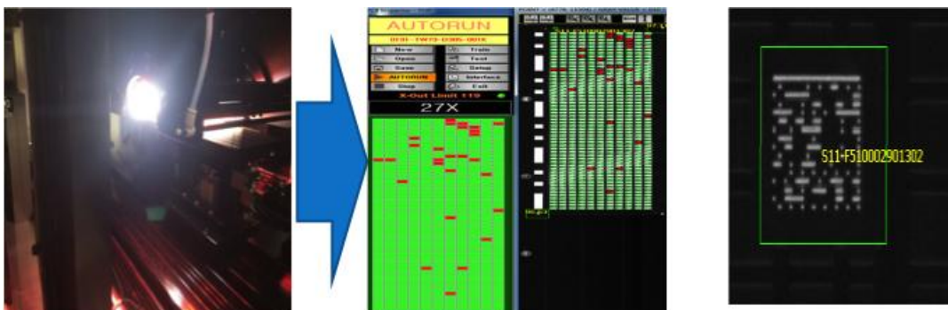
Figura 44: Escaneo e Inspección después de escanear la tira la máquina detecta el código 2D , y con el genera el archivo de la tira.
