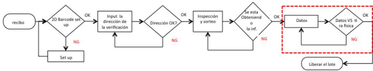
Figura 7. Flujo del Interface de sistema tecnológico ITS en MexDMT.
