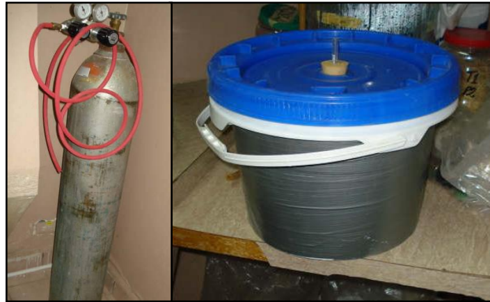
Figura 52. Tanque gasificador de CO 2 y recipiente sellado herméticamente.
