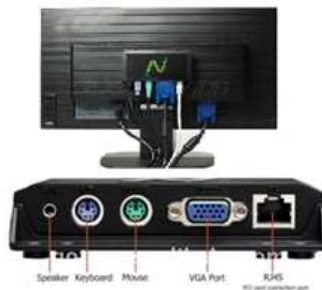
Figura 20 Conexiones de la terminal Xtenda 550, (fuente www.Ncomputin.com ).
