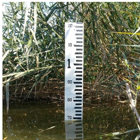
Figura 19. Regleta en el sitio de aforo DC.
