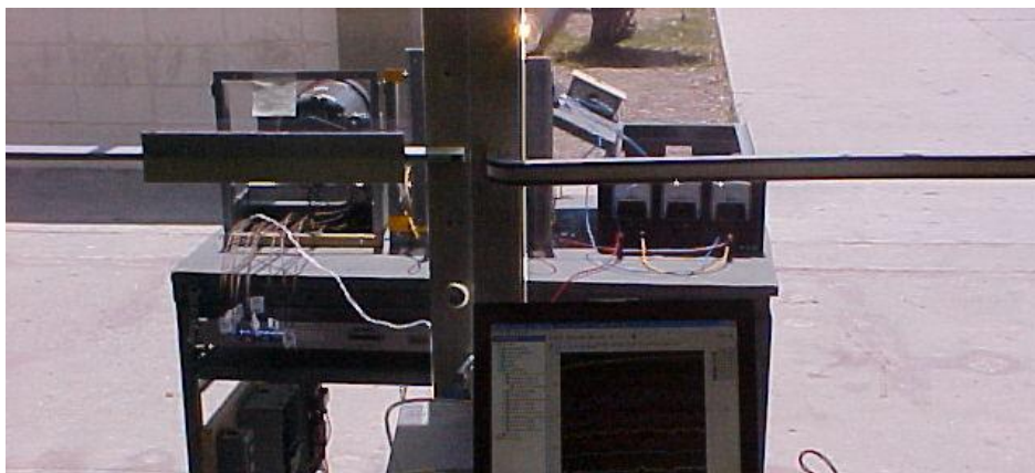
Figura 4.8 Motor operando a la intemperie con una temperatura ambiente de más de 40°C.
