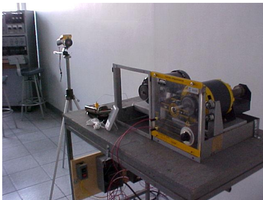
Figura 4.2 Prueba experimental con la cámara térmica.
