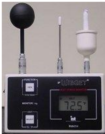
Figura 3: Equipo para medir temperatura de bulbo seco, temperatura de bulbo húmedo y temperatura radiante
