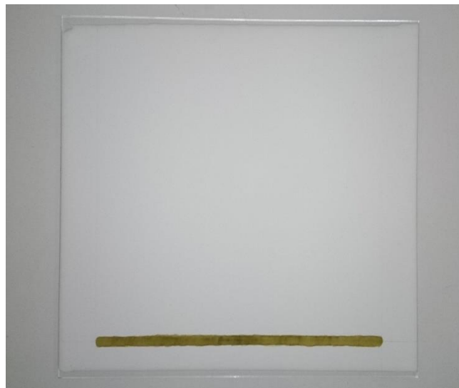
Figura 28. Cromatografía preparativa en placa previa a ser introducida a la cámara cromatográfica.
