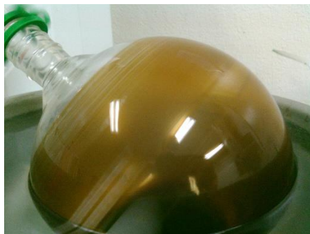
Figura 35. Extracto metanólico de Coccoloba barbadensis en rotaevaporador.
