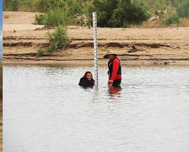
**Figura 21.** Monitoreo de regletas, búsqueda de sensor para descarga de datos.
