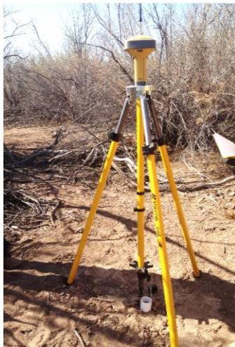
**Figura 8.** Nivelación de brocales de piezómetros con equipo GPS GR5.
