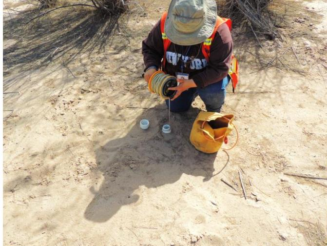
**Figura 9.** Medición manual de piezómetro.
