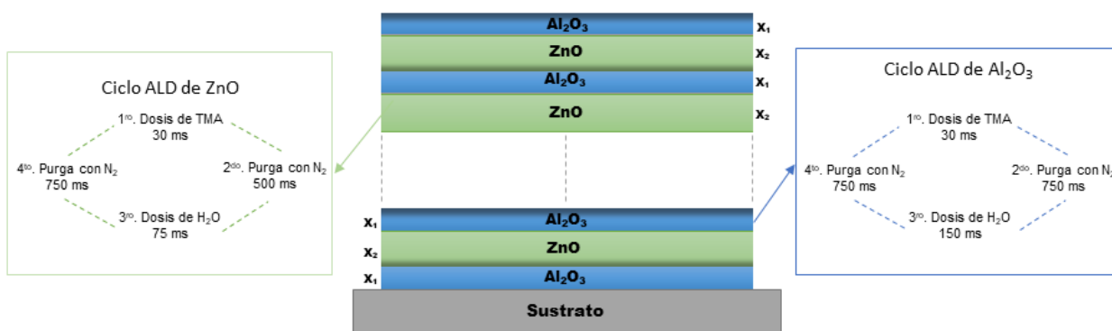
Figura 20. Geometría y ciclos ALD para el nanolaminado de \text{Al}_2\text{O}_3/\text{ZnO} .
