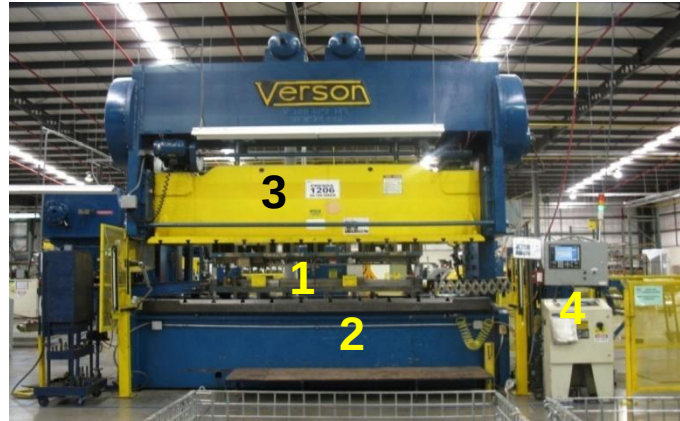
Figura 3.2 Prensa automática y sus partes principales
