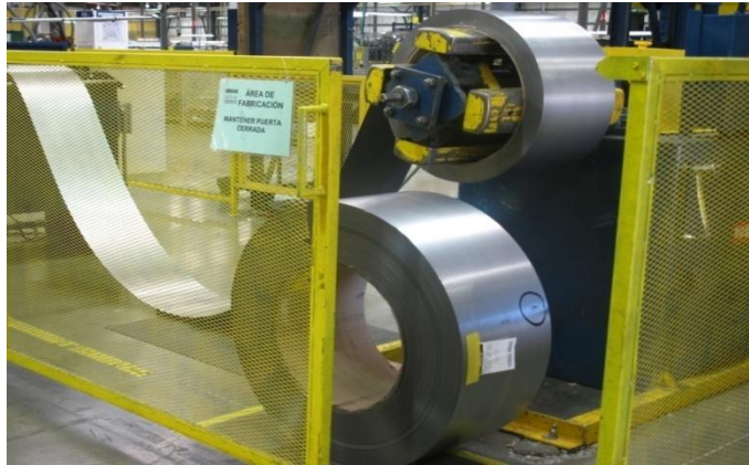
Figura 3.5 Colocación de rollo
