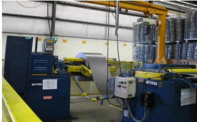
Figura 3.10 Colocación de rollo
