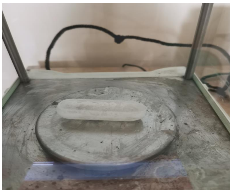
Figura 9. Cuarzo en el que se calcinará la hidrotalcita
