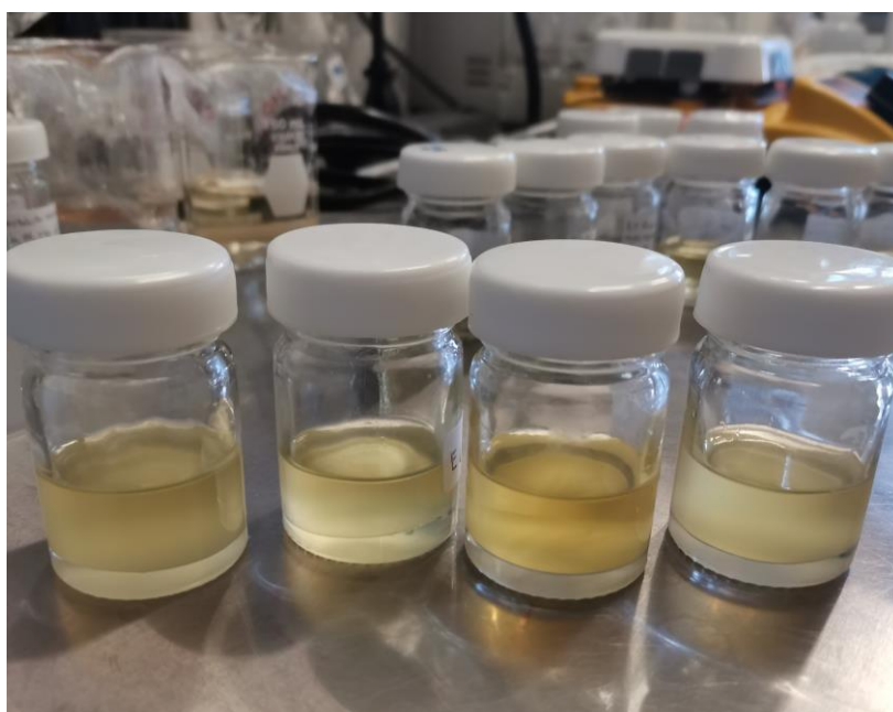
Figura 15. Muestras de biodiésel aún con catalizador
