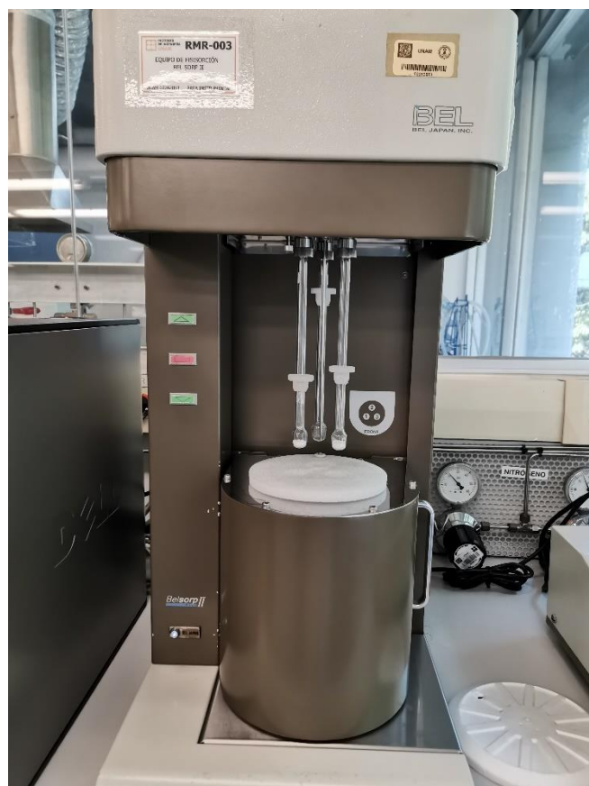
Figura 12. Equipo de fisiorción Belsorp-mini de BEL Japan a 77 K
