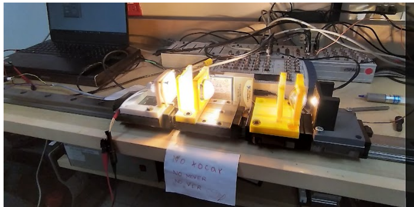
Figura 4.1 Alineación del sistema óptico A con la lámpara QTH.
