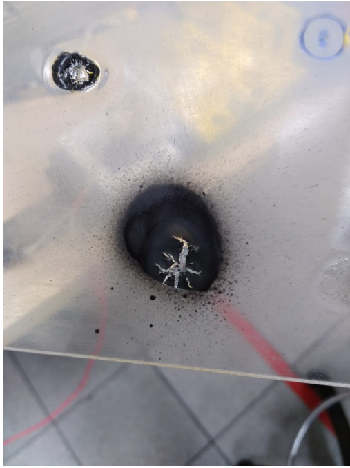
Figura 4.9 Resultado de la prueba con la pintura aerosol negra HS.
