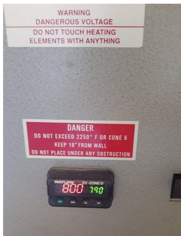
Figura 28. Tratamiento térmico de la muestra X=0.006 hasta los 800°C, (Imagen propia).
