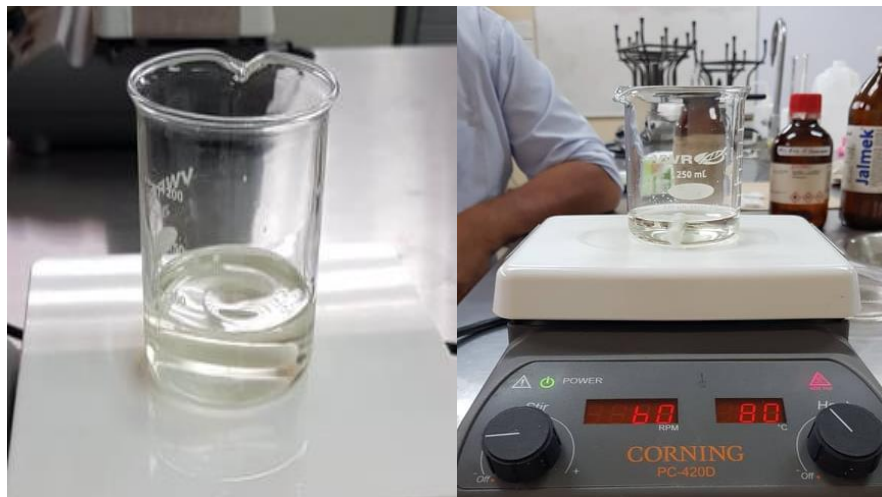
Figura 62. Proceso de Quelación después de haber añadido el Ácido Cítrico y Figura 64. Esterificación por el Etilenglicol, (Imagen propia).
