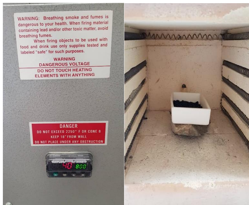
Figura 27. Tratamiento térmico para muestra x=0.004 , (Imagen propia).
