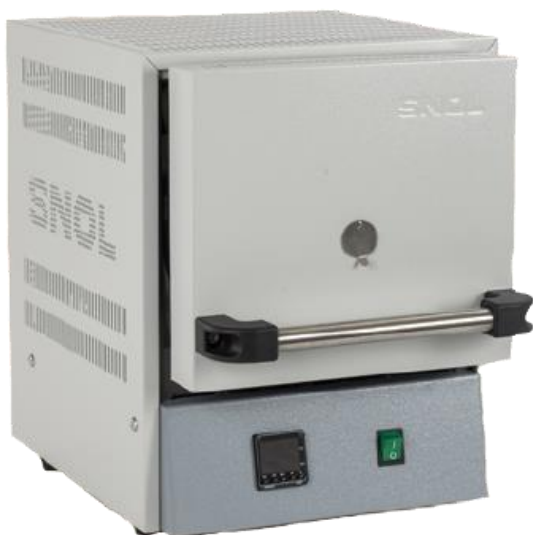
Figura 16. Cámara cerrada de alta temperatura o mufla utilizada para la calcinación de materia orgánica (Laboratorio, 2021).
