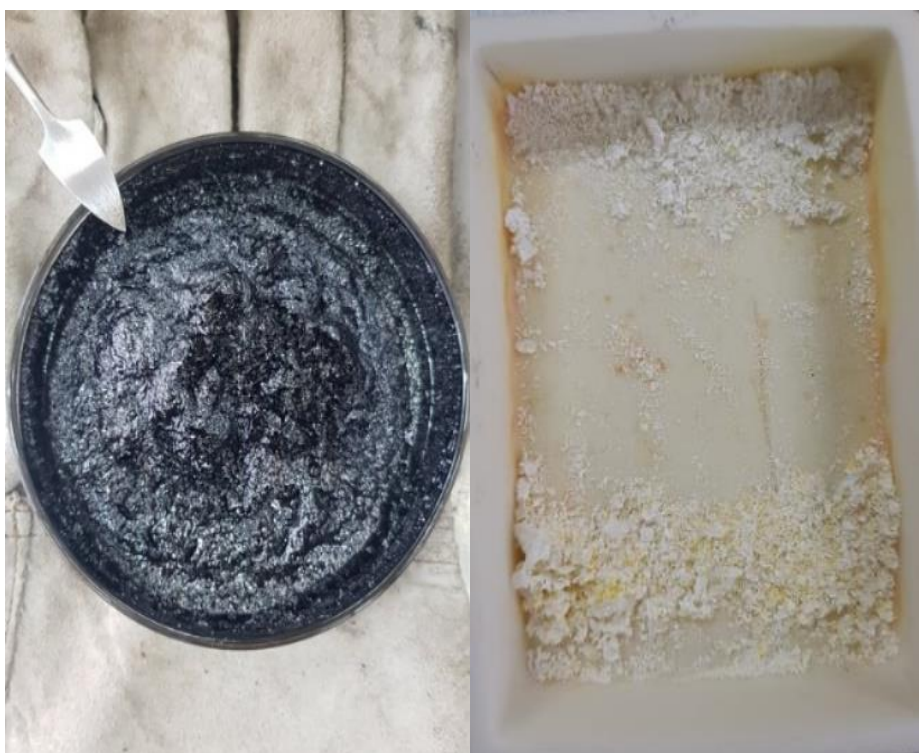
Figura 26. Muestra después de proceso de secado a 300^{\circ}\text{C} y muestra después de proceso de calcinación a 800^{\circ}\text{C} , (Imagen propia).
