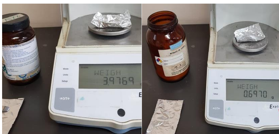
Figura 21. Nitrato de Bismuto pentahidratado \text{Bi}(\text{NO}_3)_3 \cdot 5\text{H}_2\text{O} , y Figura 22. Nitrato de sodio \text{NaNO}_3 , (Imagen propia).
