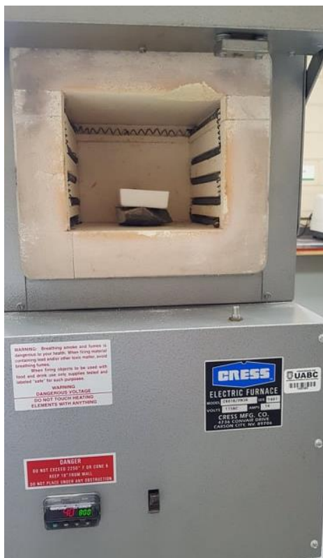
Figura 29. Tratamiento térmico de la muestra X=0.008 hasta los 800^{\circ}\text{C} , (Imagen propia).
