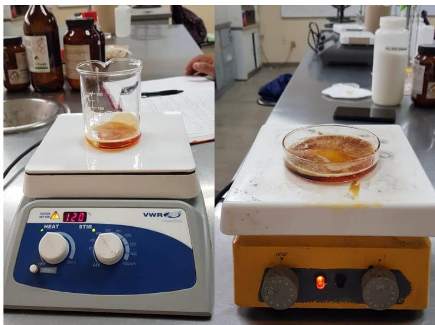
Figura 63. Polimerización obtenida después del tratamiento térmico durante 24hrs, (Imagen propia).
