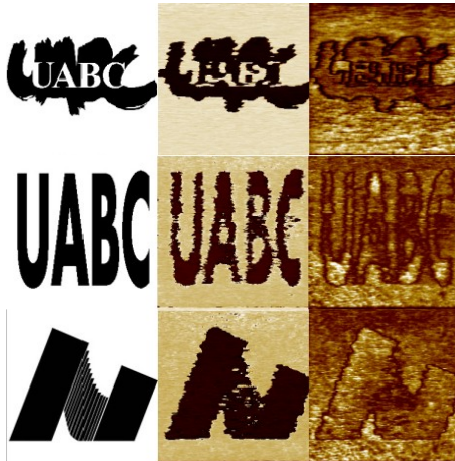
Figura 25. Logotipos de UABC y CNYN. Izquierda patrón a grabar, en medio patrón grabado en el dominio de la fase en la muestra de PZT, derecha fampitud. Área de barrido 10\ \mu\text{m} , resolución 256 \times 256 , temperatura 22^\circ\text{C} , humedad 4.3\% , frecuencia de resonancia 200\text{KHz} , frecuencia de barrido 0.25\text{Hz} .
