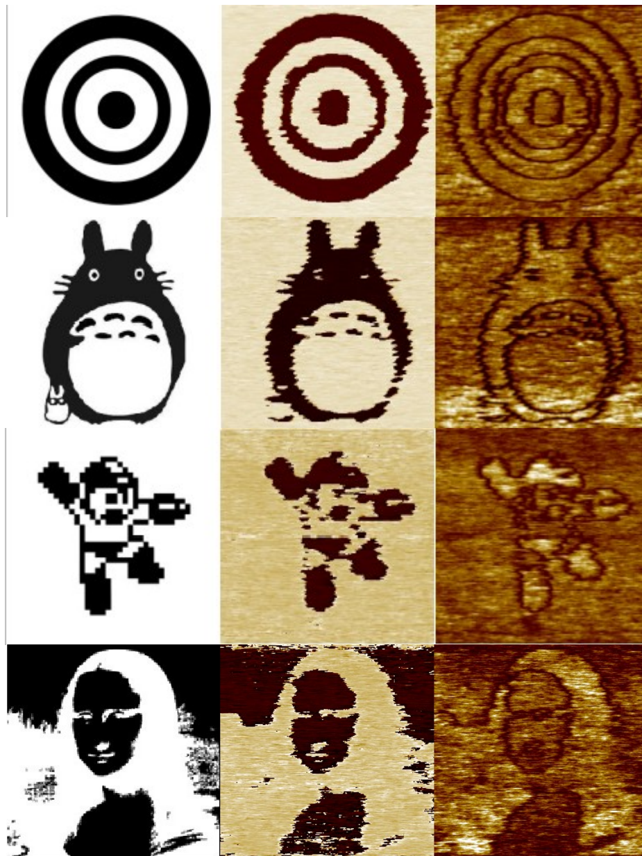
Figura 26. Imágenes variadas. Izquierda patrón a grabar, en medio patrón grabado en el dominio de la fase en muestra de PZT, derecha amplitud. Área de barrido 10\ \mu\text{m} , resolución 256 \times 256 , temperatura 22^\circ\text{C} , humedad 1.3%, frecuencia de resonancia 200KHz, frecuencia de barrido 0.25Hz.
