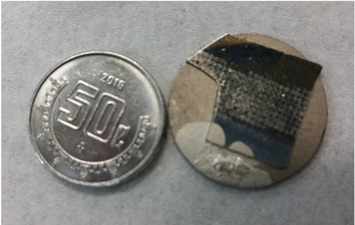
Figura 20. Muestra de PZT sobre porta muestras con pintura de plata para asegurar la conductividad. Moneda como escala.
