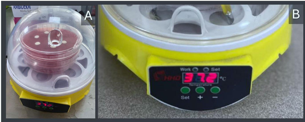
Figura 14. Proceso de incubación. En la primera fotografía se aprecia la colocación de las placas dentro de la incubadora. En la segunda fotografía se muestra el ajuste de la temperatura a 37.2 °C.
