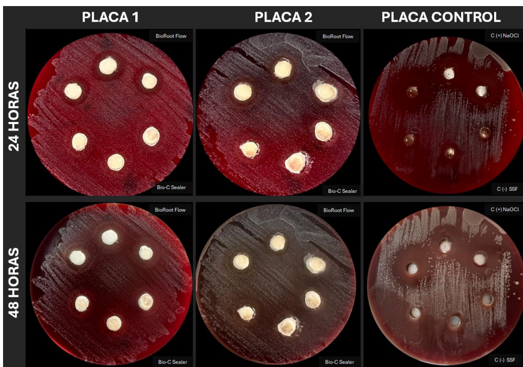
Figura 22. Resultados de las pruebas de difusión en agar técnica evaluada por halos de inhibición a las 24 y 48 horas. Esquema del registro fotográfico de resultados de la segunda prueba por difusión de cementos en agar gelosa sangre al 5%. Donde (A): cemento "A"; (B) cemento "B"; (C+): control positivo/NaOCl; (C-): control negativo/SSF.
