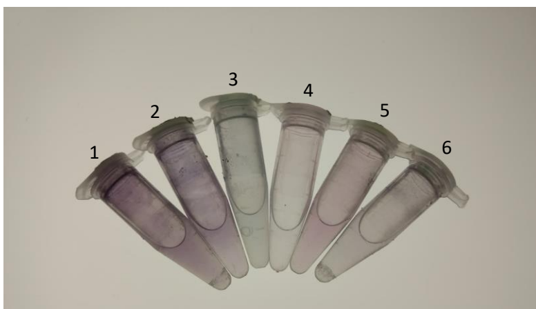
Figura 18. Muestras obtenidas después del ciclo de limpieza, conteniendo NPsAu suspendidas en alcohol isopropílico. A: 0.013 mL/min en todas, B y C: 1) 0.008, 2) 0.006, 3) 0.016, 4) 0.002, 5) 0.004 y 6) 0.014, todo en unidades de mL/min.
