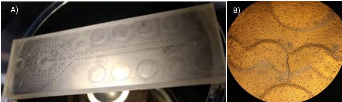
Figura 9. Molde patrón impreso y limpio con el microcanal en la superficie. A) Sistema microfluídico en tamaño real fabricado por impresión 3D, B) Detalle de una sección del molde vista en un microscopio.
