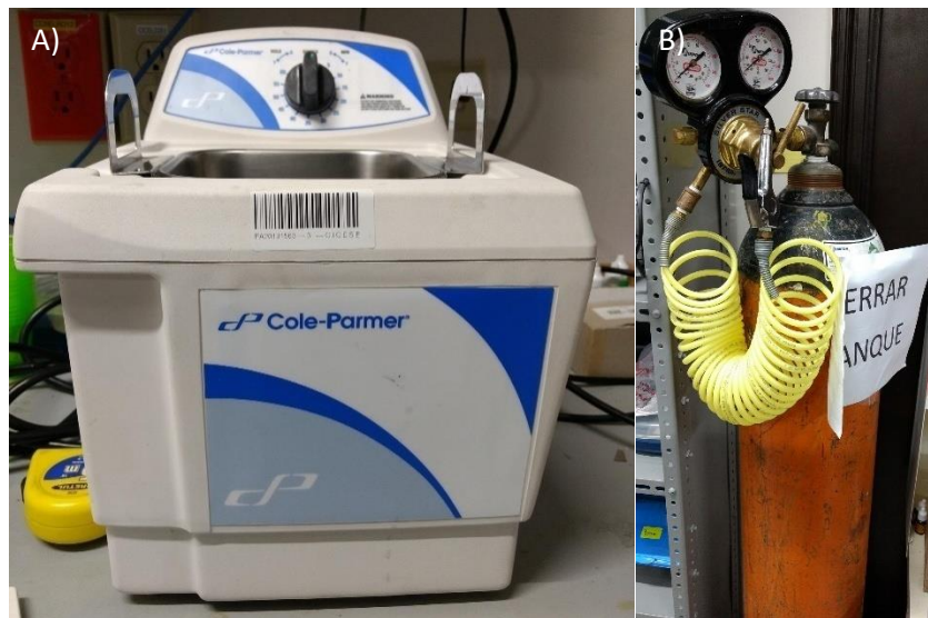
Figura 13. Limpieza del portaobjetos (Sustrato de vidrio). A) Baño ultrasónico de acetona durante 5 minutos, B) Tanque con nitrógeno para secado y eliminación de residuos.
