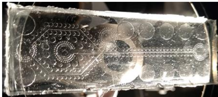
Figura 14. Dispositivo microfluídico terminado con el microcanal grabado en PDMS pegado a un portaobjetos.
