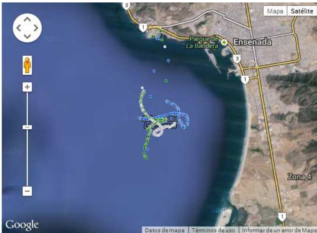
Figura 3.9: Desplazamiento registrado por el dispositivo instalado en boyas de deriva liberadas en océanos semi-abiertos.
