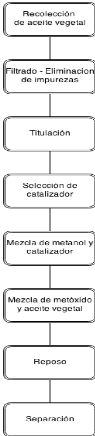
Figura 2.4 Proceso de producción de biodiesel. Fuente: Propia
