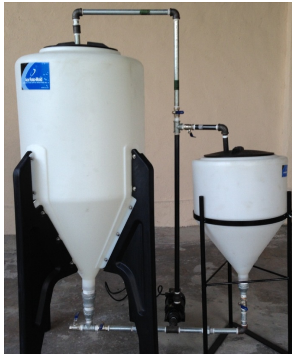
Figura 3.6 Prototipo de reactor para producción de biodiesel, Fuente: Propia
