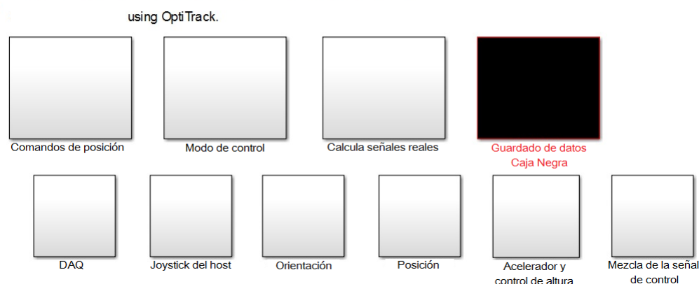
Figura 12.5.1: Controlador de vuelo del QBall 2 en Simulink.
