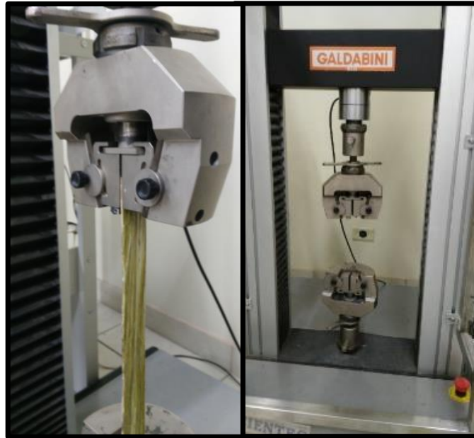
Figura 12. Probetas montadas máquina de tracción.
