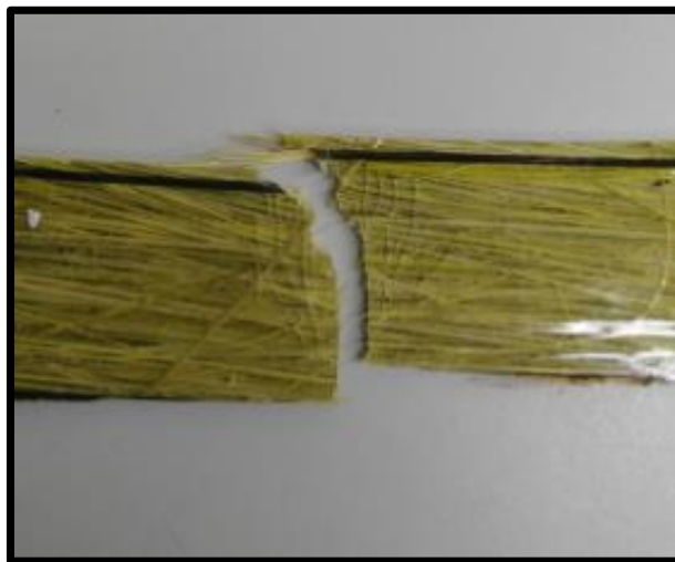
Fractura de la probeta 1 concentración 70%/30%5 min de exposición (acetilación)
