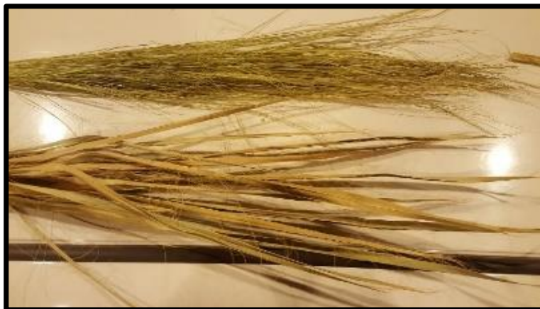
Figura 6. Fibras de palma antes (abajo) y después (arriba) del proceso de rastrillado.
