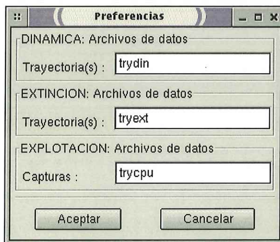
Figura A8. Ventana flotante a través de la cual el usuario escribe los nombres de los archivos que el sistema GtkPDS crea para guardar los datos de salida generados por la simulación de cada uno de los procesos.
