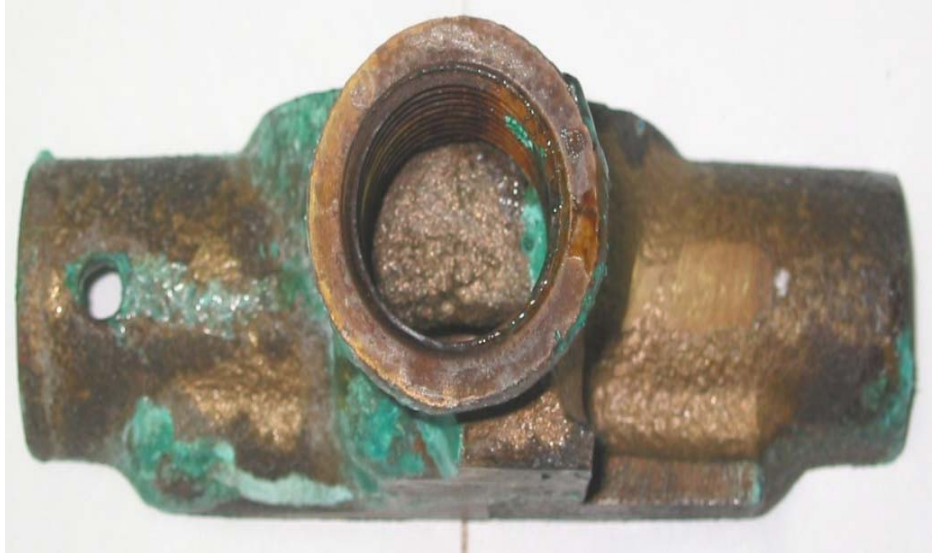
Figura 20 Muestra C, aleación de cobre C 84400, modificada por ASTM B584, moldeada en arena código de identificación 17196-0100.
