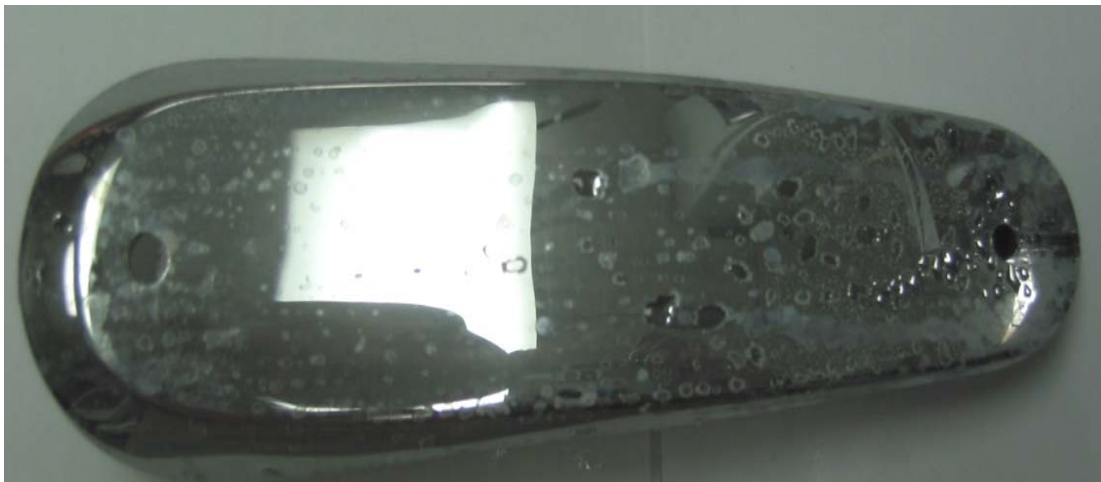
Figura 21 Muestra D, aleación de cobre libre en plomo tipo 3 (Bi-Se), molde permanente grado D, código de identificación 24796-01XX.
