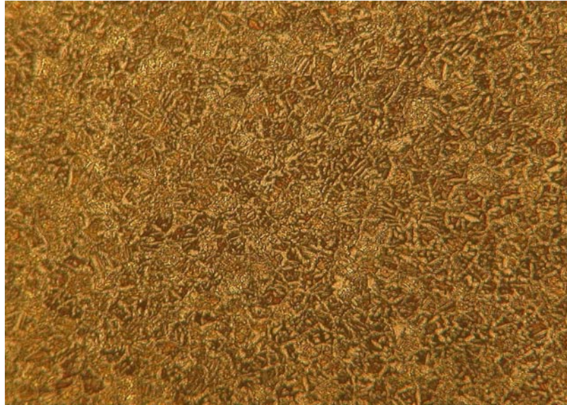
Figura 17 Microestructura de muestra D. aleación de cobre Bi-Se, en molde permanente, Clase 1, grado D, Tipo 3: Microestructura de grano fino distribuido homogéneamente, característico de piezas moldeadas en molde permanente, matriz alfa con zonas de la fase beta, obsérvese que no se aprecia plomo en los límites de grano, reactivo de ataque \text{HNO}_3\text{-CH}_3\text{COOH-H}_3\text{PO}_4 (100X).
