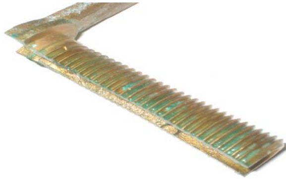
Figura 18 Muestra A, aleación de cobre C 37700 por LOTA BRASS, molde permanente, código de identificación 26994-0200.
