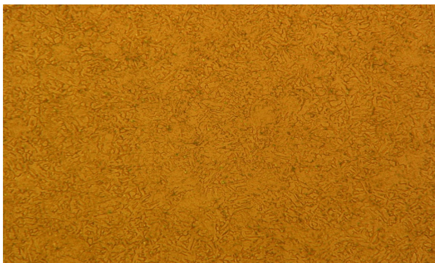
Figura 14 Microestructura de muestra A.- aleación de cobre C 37700 por LOTA BRASS, molde permanente, código de identificación 26994-0200. Grano fino. Esta microestructura presenta dendrita en una matriz alfa, debido a un enfriamiento rápido, por ser obtenida en molde permanente, atacada con \text{HNO}_3\text{-CH}_3\text{COOH-H}_3\text{PO}_4 (100X).
