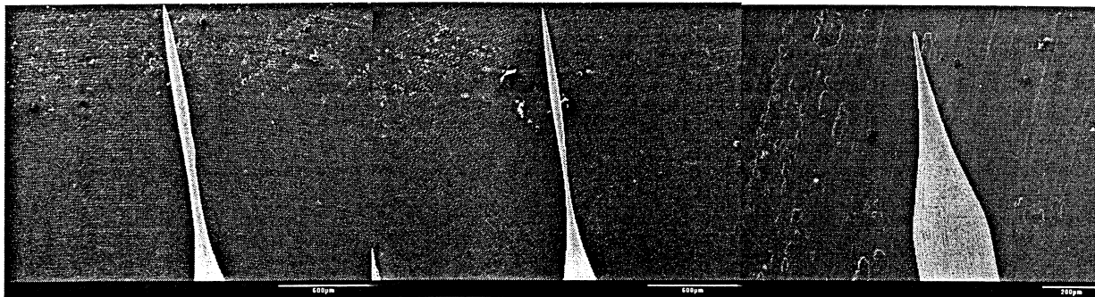
Figura. 3.7. Puntas fabricadas usando el método alterno. (a) nivel de referencia 1.9V; (b) nivel de referencia 1.8V; (c) nivel de referencia 1.72V.
