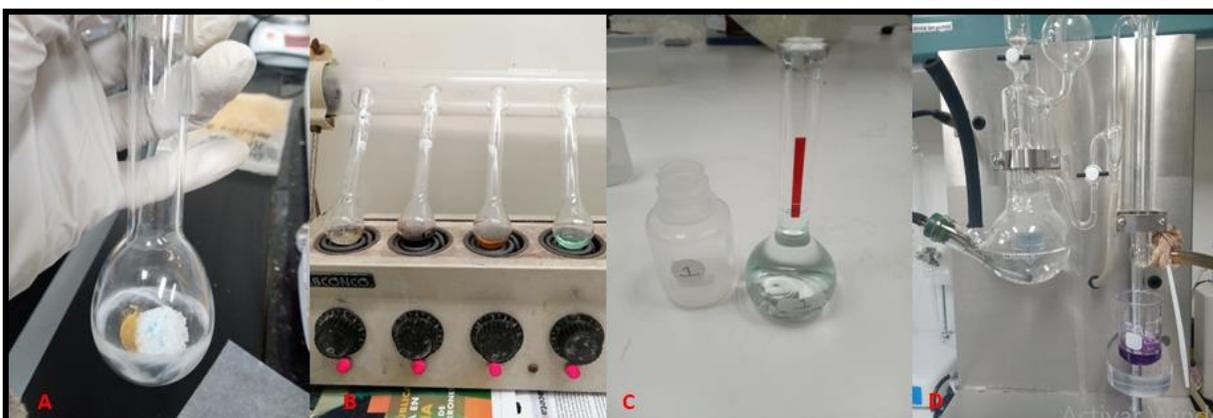
Figura 3: Proceso para proteínas totales: (A) reactivos y dieta triturada, (B) matraces microkjeldahl en su proceso de digestión, (C) digerido aforado y envasado a 25 ml y (D) destilador Kjeldahl.
