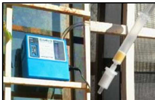
Figura 14. Bomba de muestreo y cartucho con celulosa impregnada con 2-4 DNHP y Scruber (KI).
