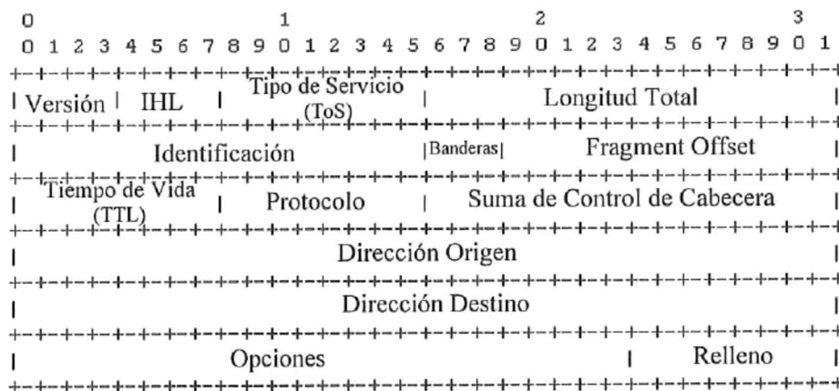
Figura 18.- Formato del Encabezado de IPv4.
