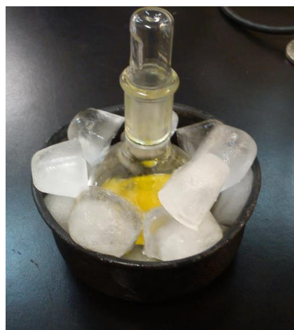
Figura 9. Sistema utilizado para la preparación de los precursores, 9a el sistema de calentamiento y 9b el sistema de baño de hielo.
