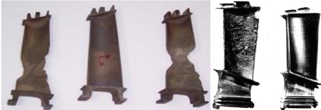
**Figura 4.-** Ábale de turbina después de 2500 horas de vuelo (Sin recubrimiento, izquierda), Y con recubrimiento de NiAl (Derecha).<sup>9</sup>
