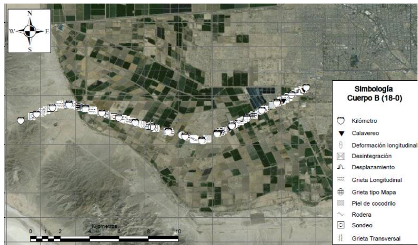
Figura 4.2 Deterioros presentes en el cuerpo descendente “B” del km 0+000 al 18+000.
