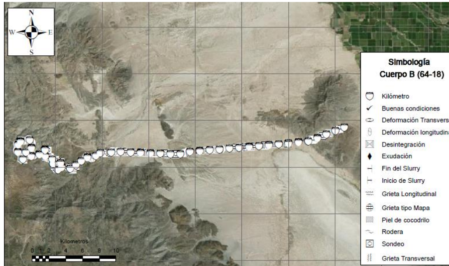
Figura 4.4 Deterioros presentes en el cuerpo descendente “B” del km 64+000 al 18+000.
