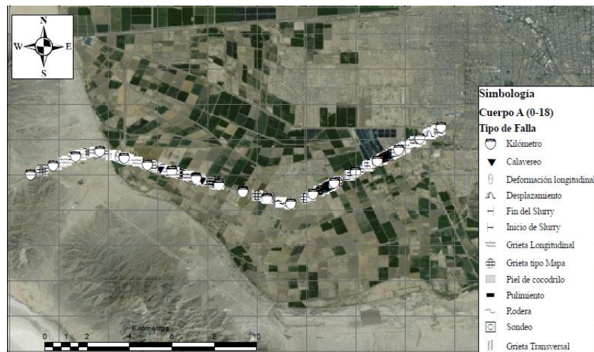
Figura 4.1 Deterioros presentes en el cuerpo ascendente “A” del km 0+000 al 18+000.
