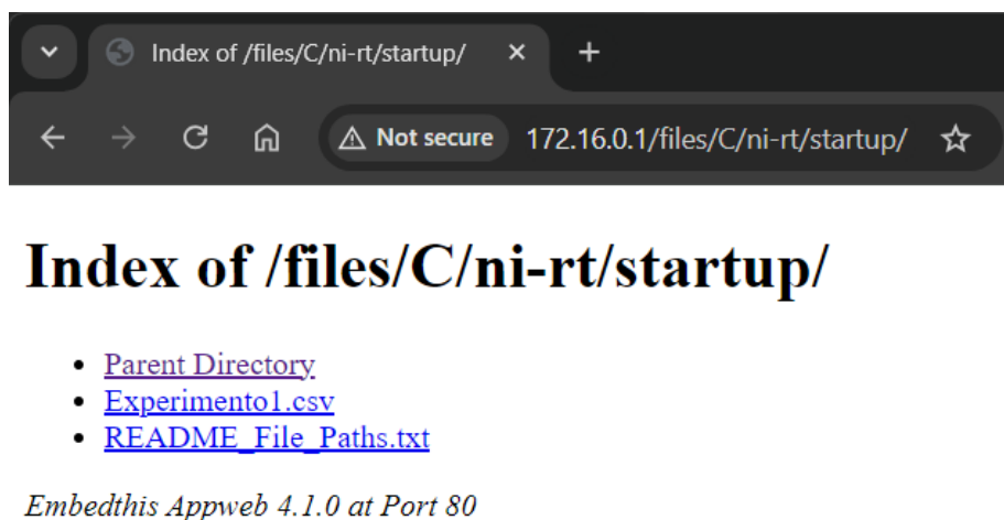
Figura 4.7: Directorio interno de la MyRIO para el acceso a los experimentos guardados internamente.
