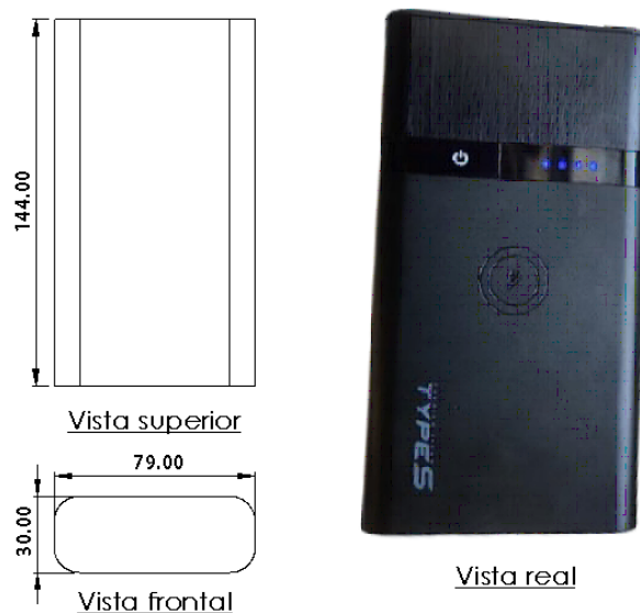
Figura 3.11: Diagrama con medidas de la batería de alimentación del RMO.
