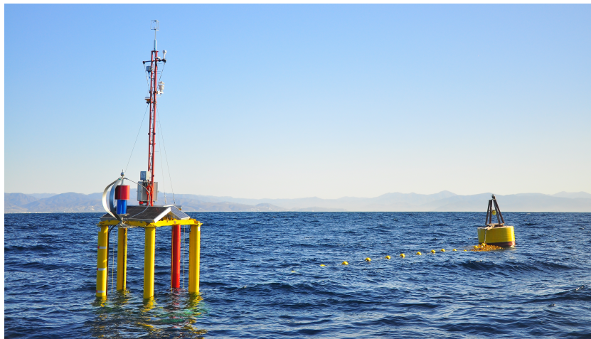
Figura 2.1: Fotografía de la BOMM (izq.) y la boya Tether (der.), instaladas cerca de la Isla Todos Santos, Ensenada, B.C.
