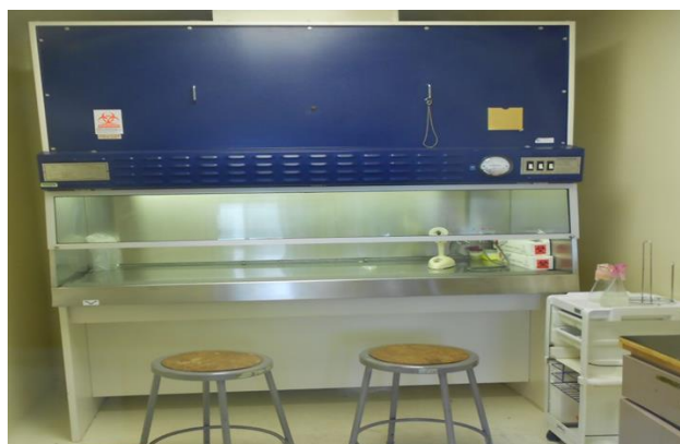
Figura 2. Campana de flujo laminar del laboratorio de análisis microbiológico de la Facultad de Ciencias Químicas e Ingeniería, UABC.
