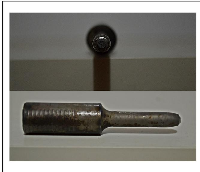
**Figura 3.36** Fractura del acero 1018 con temple en prueba de tensión.
