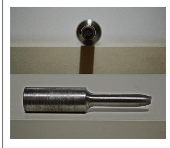
**Figura 3.32** Fractura del acero 1018 sin tratamiento térmico en prueba de tensión.
