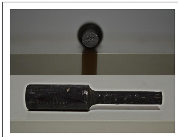
**Figura 3.40** Fractura del acero 1018 con nitruración en prueba de tensión.
