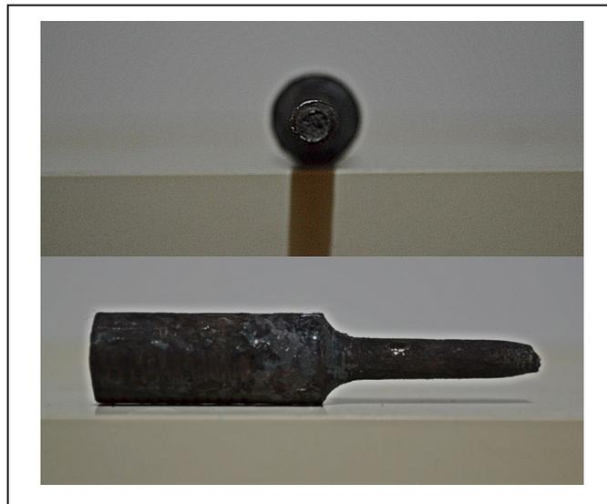
**Figura 3.34** Fractura del acero 1018 con recocido en prueba de tensión.
