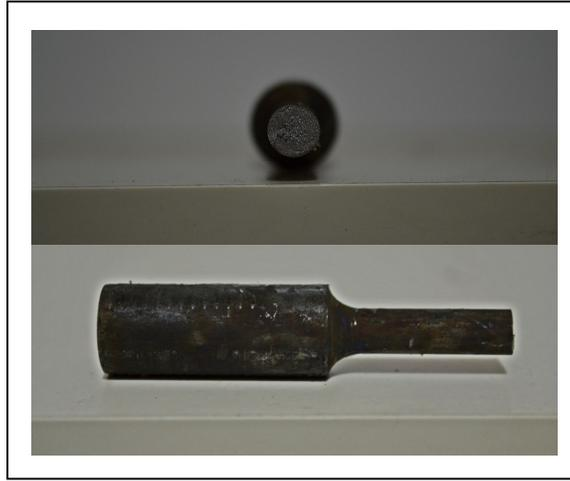
**Figura 3.38** Fractura del acero 1018 con cementación en prueba de tensión.
