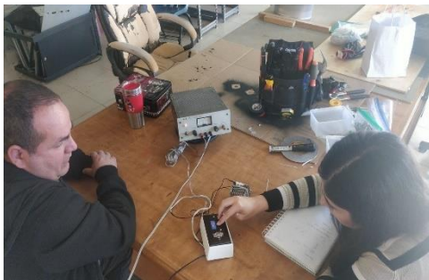
Prueba de funcionamiento de control PID.
