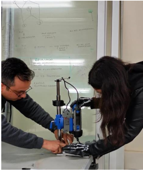
Perforación de placa de aluminio 5052
