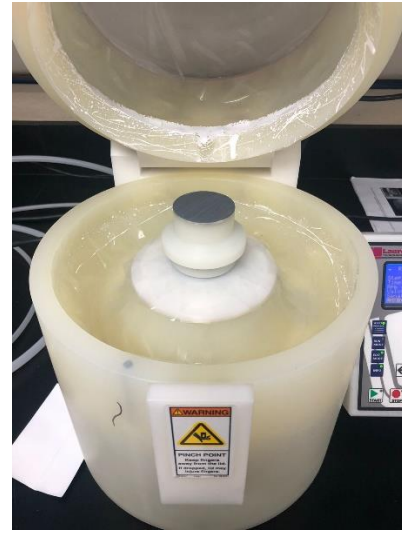
Colocación de sustrato de aluminio 5052 sobre plataforma giratoria
