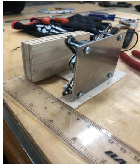
Ensamblaje de placa de aluminio 5052 a disipador
