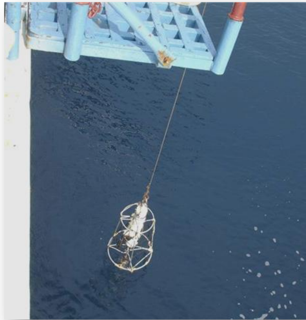
Figura 12.- Lance del CTD marca Seabird , para la obtención de características hidrográficas en la columna de agua, durante las trayectorias realizadas con el ADCP .
