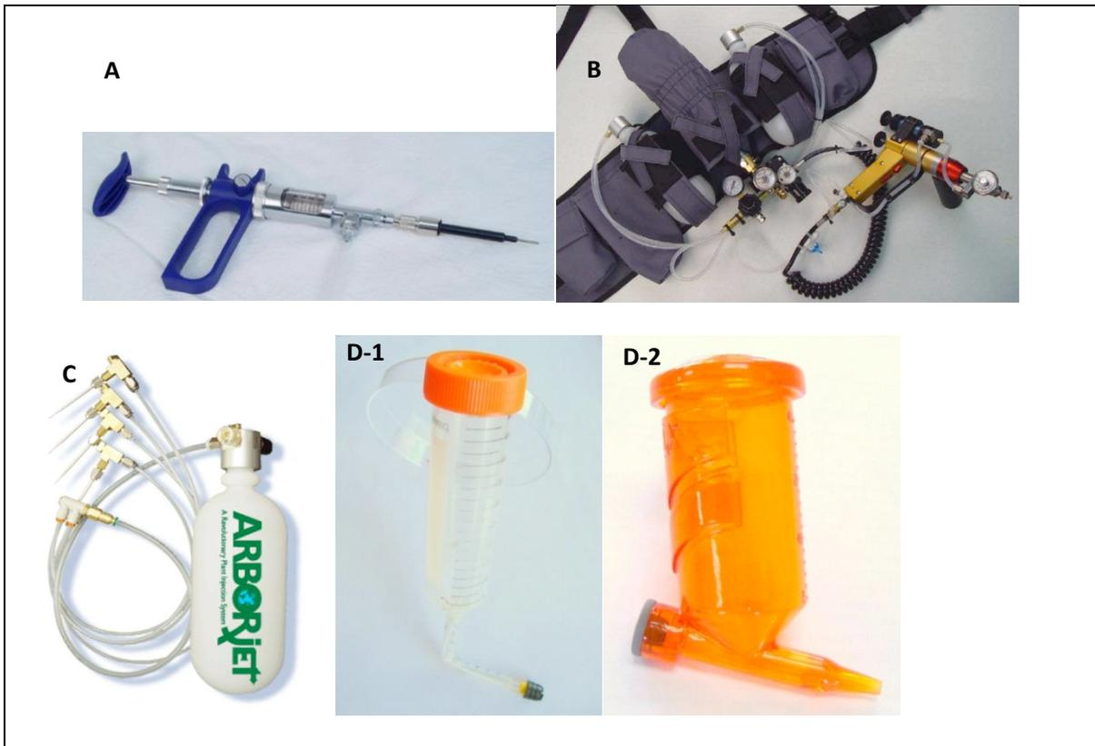
**Figura 4-2:** Sistemas para inyección de tratamientos a plantas: (A) Sistema de micro-inyección QUIKjet; (B) Sistema hidráulico de micro-inyección Viper; (C) Sistema de micro-infusión Tree I.V. y (D-1) Dispositivo para micro-difusión XyllaKill, desarrollado en el laboratorio y (D-2) modelo final del mismo dispositivo XyllaKill.
