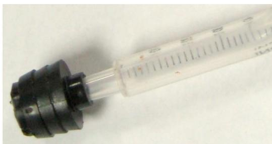
**Figura 5-2:** Compatibilidad entre la boca de la jeringa y la válvula arborplug.
