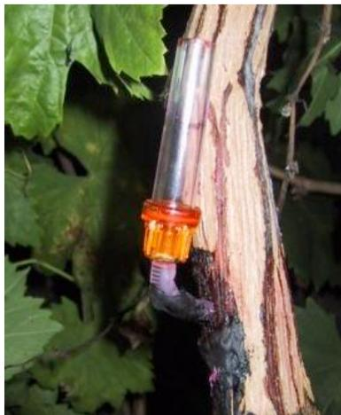
**Figura 5-1:** Primer prototipo del dispositivo XyllaKill conectado a una planta de uva.
