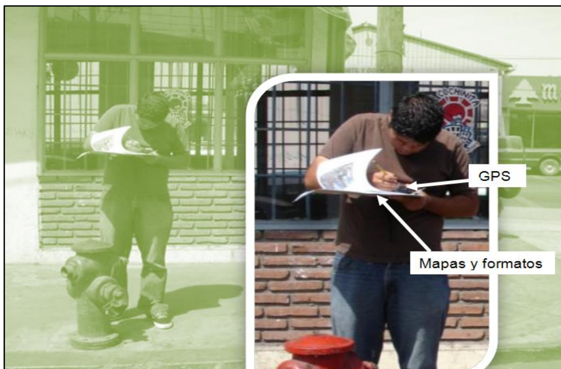
Figura 2.4 Levantamiento de información de hidrantes
