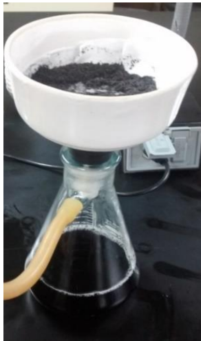
Figura 16. Filtrado al vacío con un embudo Büchner.
