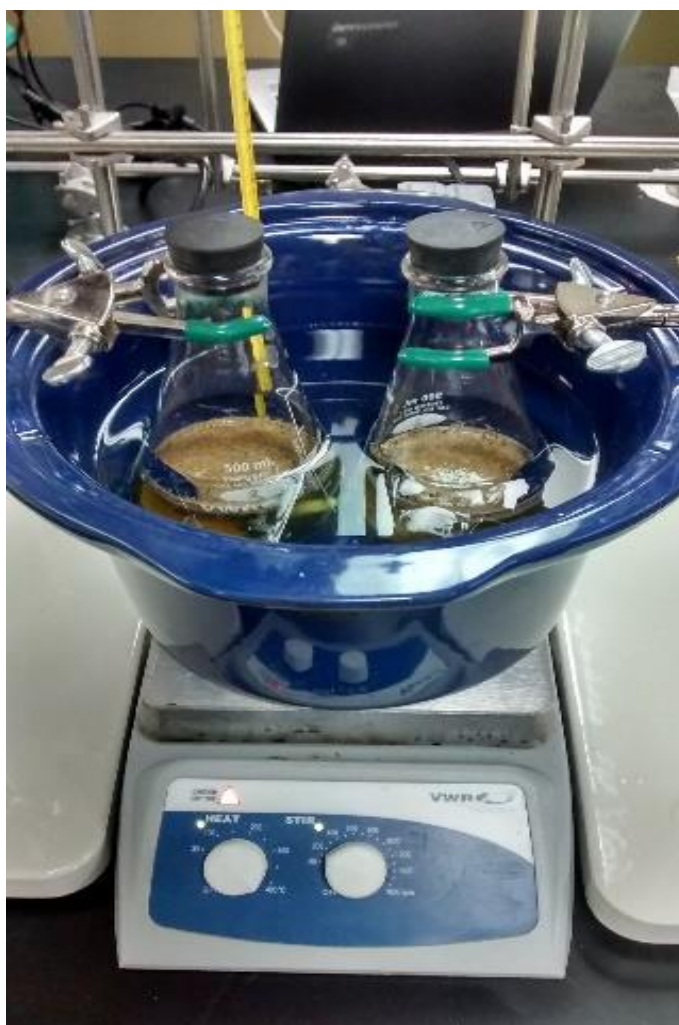
Figura 18. Determinación de holocelulosa.
