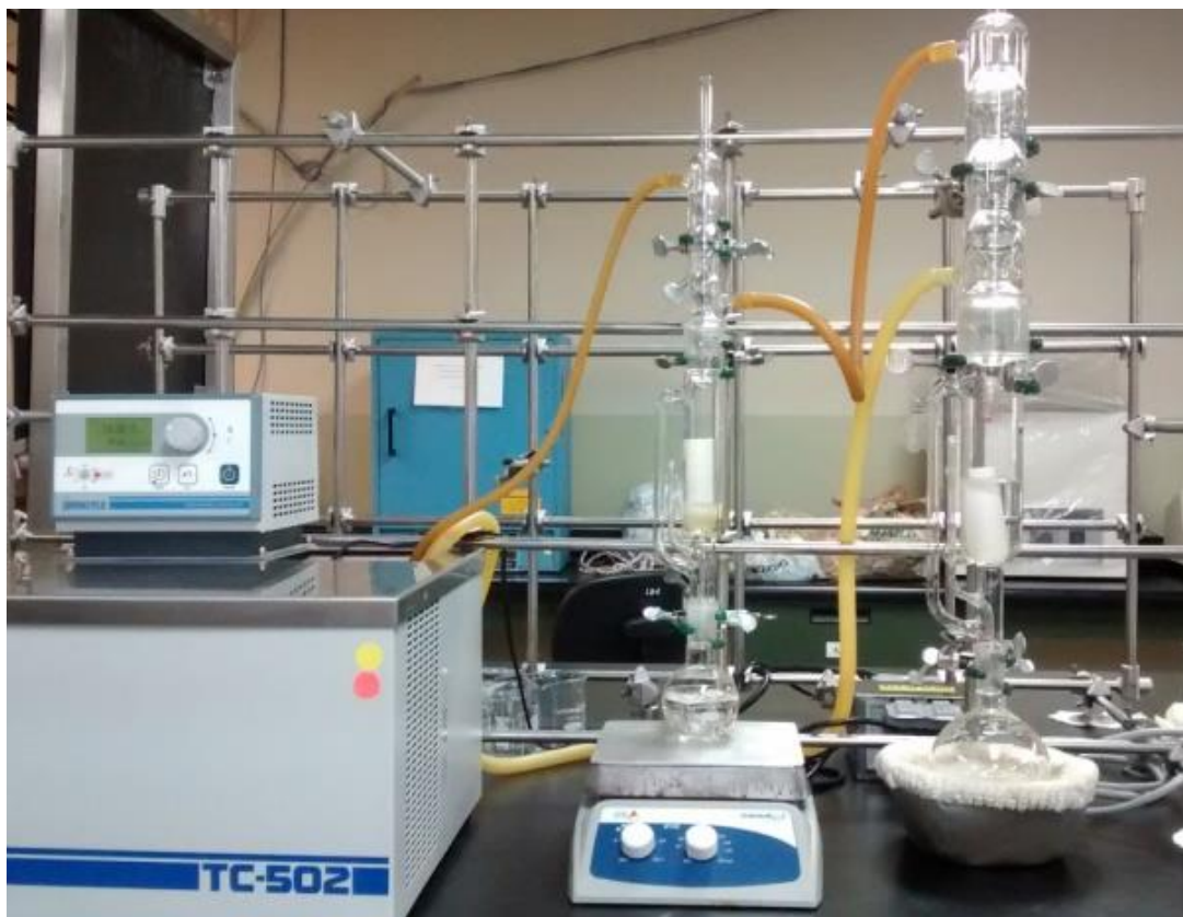
Figura 14. Extracción Soxhlet con acetona.
