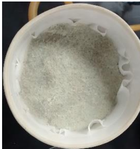
Figura 38. Residuo de holocelulosa.
