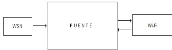
Figura 5.2: Arquitectura abstracta de la plataforma e-salud
